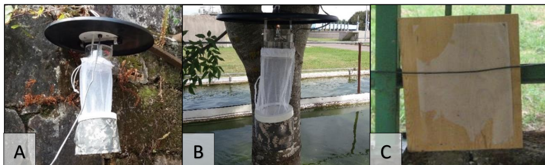
Figura 6. Trampa CDC de luz ultravioleta na vivenda de Arbo (A), trampa CDC de luz branca na EDAR de Tui (B) e trampa de ricino na piscina municipal de Guitiriz (C).
