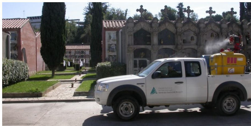
Foto 1: Maquinaria ULV montada sobre vehículo, empleada en el artículo 4.1 de la presente memoria de tesis realizando un tratamiento adulticida
